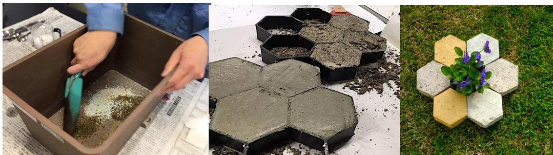
写真1 左：配合の様子、右：成形作業、右：完成したブロック
