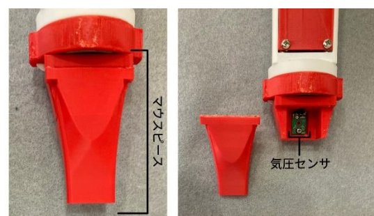
図 7 マウスピースと気圧センサ
