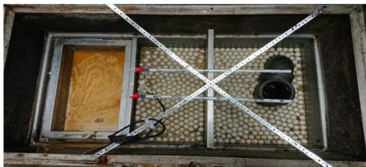
生協食堂の排水溝内に臭気抑制システムを導入して試験を実施
